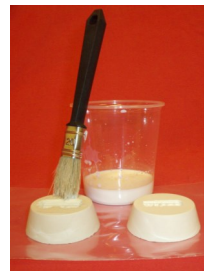
Gipslak met de kwast aanbrengen op uitgehard gips.
